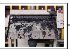
④シュート洗浄用配管 マグネットセパレータからの 戻り液を利用し、シュート 上のスケールを洗い流し スケール回収タンクへ送る。
