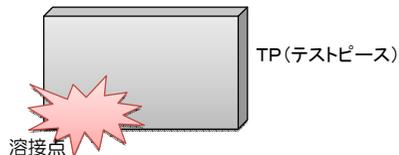
溶接点から15mm・30mm離れた位置にTPを設置し、メック・ノンスパッターを処理した場合と処理していない場合のスパッター付着具合を確認。
